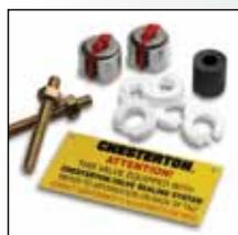
I set Live Loading 1724E uniscono una baderna intrecciata di PTFE 1724 e i vantaggi che fornisce il Live Loading. Il sistema è approvato TA-Luft e fornisce un eccellente controllo delle emissioni e la massima compatibilità con le sostanze chimiche. I set possono essere utilizzati su valvole di blocco, valvole motorizzate e valvole di controllo.
