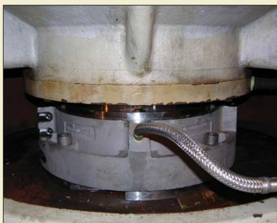
L'installazione e la riparazione delle tenute split vengono portate a termine senza smontare i macchinari, risparmiando tempo per la manutenzione e costi d'esercizio.
